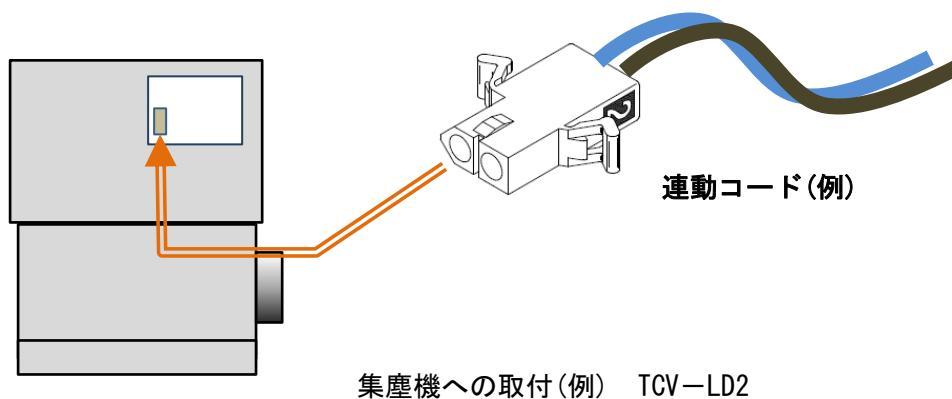
VF-5N は、遠隔操作の設定：D パターンで使用します。集塵機の取扱説明書を参照ください
