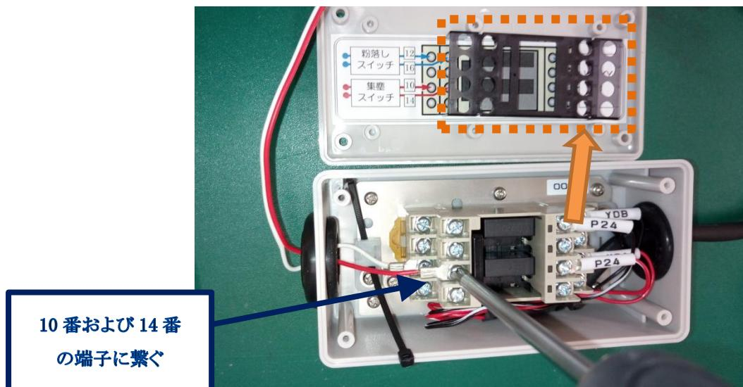
6. 結束バンドを締め、集塵機からのコードが抜けないようにします。黒いカバーを嵌めます。
