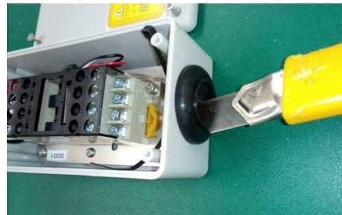
5. 黒いカバーを外し、集塵スイッチ端子のネジ(10)番、(14)番を緩めて集塵機の運動スイッチコードを取り付けます。
