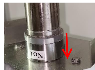
隙間がないことを確認
