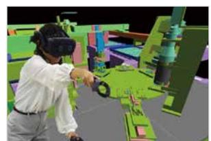
仮想試作機上で組立性検討を行い、生産準備業務のフロントローディング、品質向上と効率化を実現します。組立手順、工数算出、工程設計（山積み/山崩し）、リソース検討、組立性評価、業務帳票作成や作業教育などの生産準備業務を支援します。
