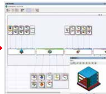
工程単位の工程ブロック図
