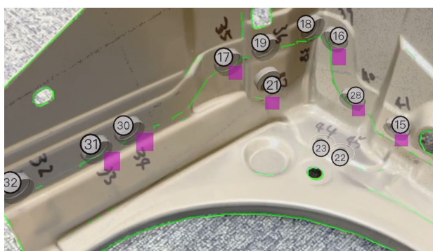
AIによるスポット溶接打点自動検出
